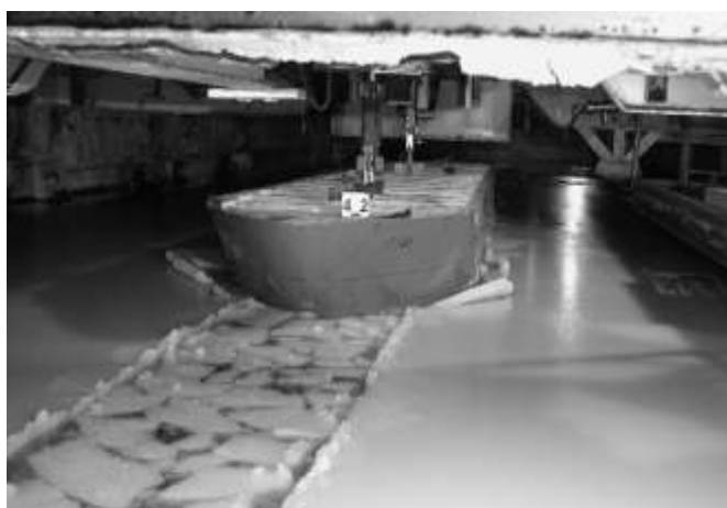
Рис. 2. Движение крупнотоннажного судна по каналу, проложенному ледоколом
