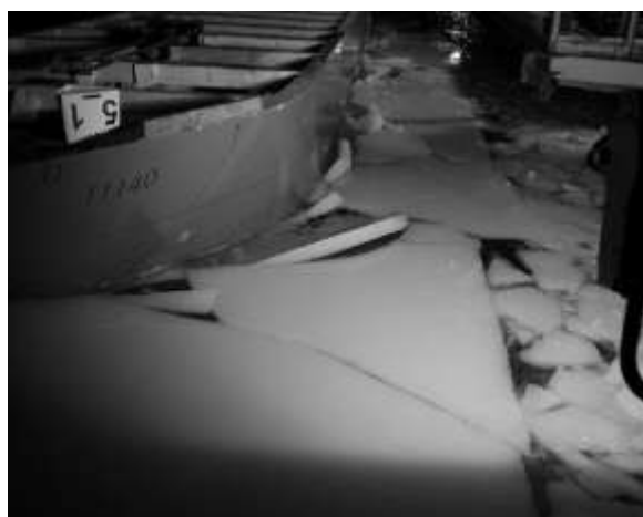
Рис. 3. Движение крупнотоннажного судна параллельно каналу, проложенному танкером
