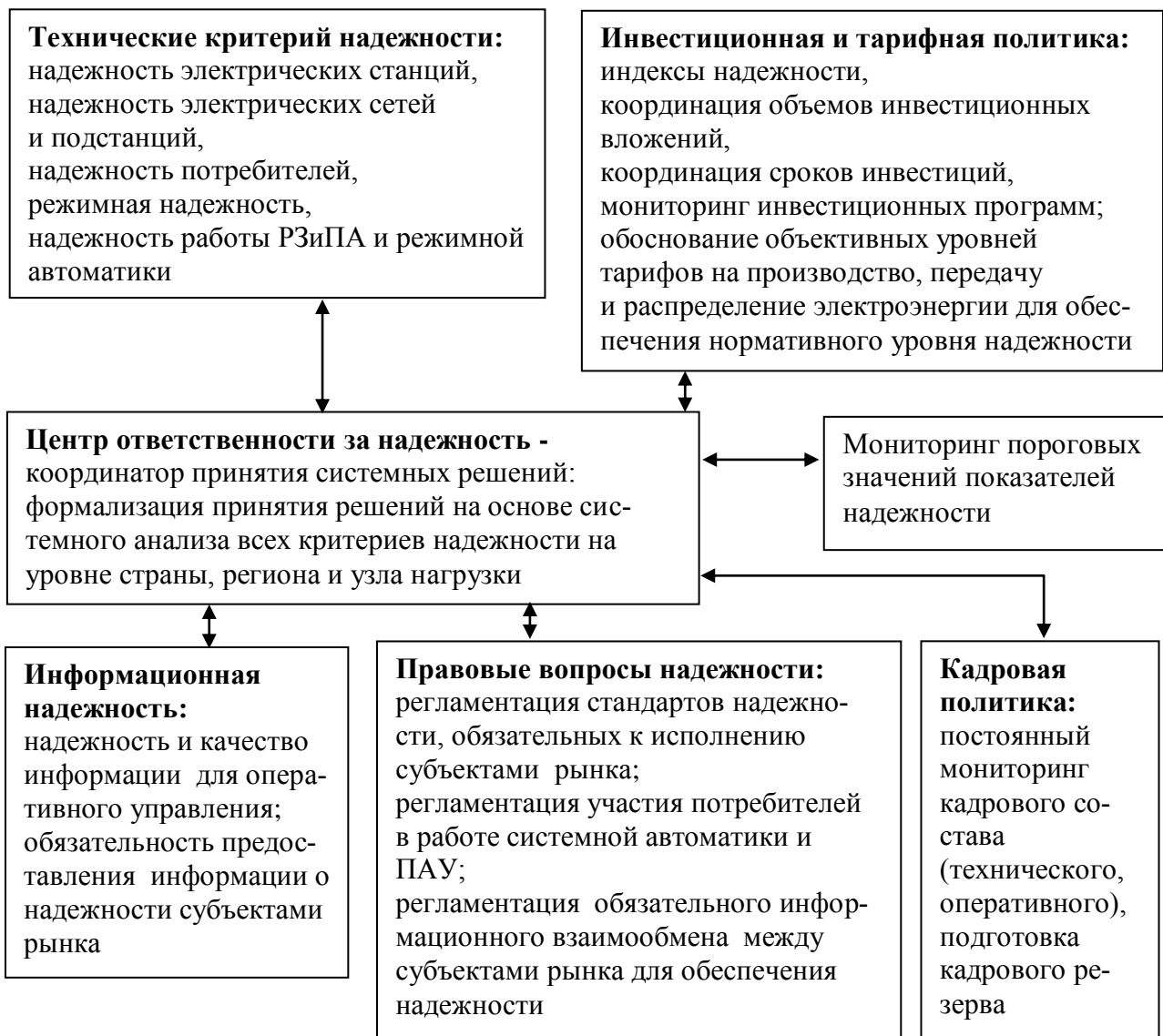
Рис. 4. Модель обеспечения и управления системной надежностью и надежностью электроснабжения
