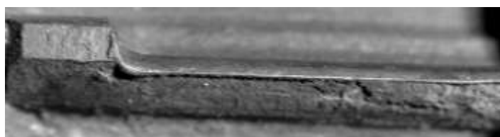
Рис. 9. Фотография вершины зуба шестерни со следами пластической деформации и отслаивания стали
