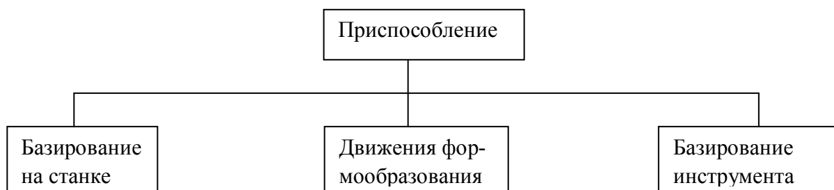
Рис. 2. Функциональная схема приспособления
