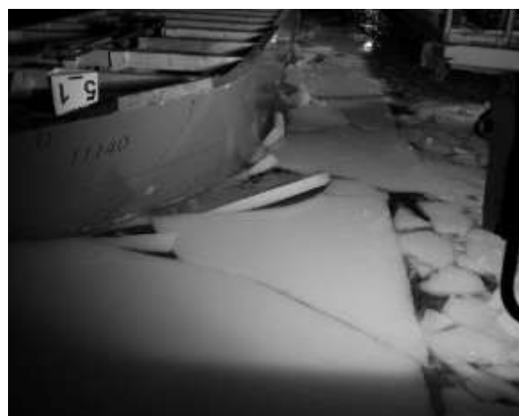
Рис. 3. Движение крупнотоннажного судна параллельно каналу, проложенному танкером
