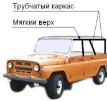
Рис. 4. Общий вид измененной конструкции кузова
