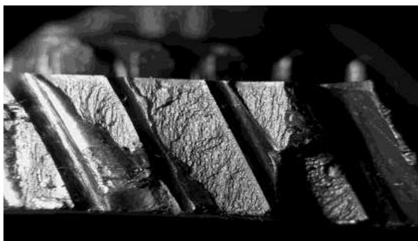
Рис. 1. Усталостный излом зубьев ведомой шестерни
