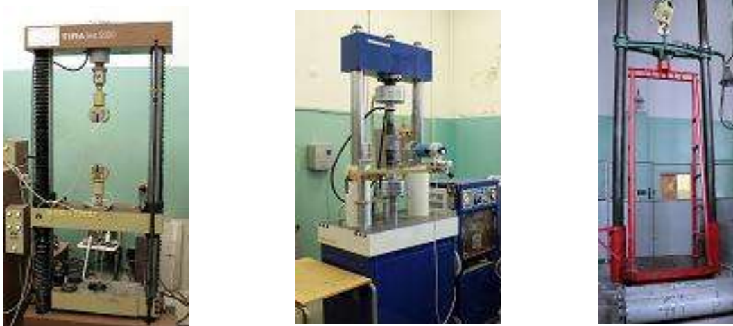
а) б) в) Рис. 8. Оборудование для испытаний демпфирующего блока макета радиального страховочного подшипника
