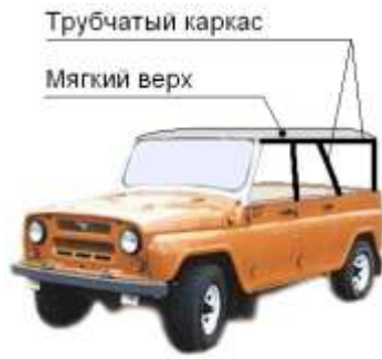
Рис. 4. Общий вид измененной конструкции кузова
