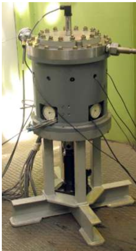
в) Рис. 6. Стенд для определения газостатических характеристик сегмента осевого страховочного подшипника: а – дроссель; б – сегмент; в – общий вид стенда
