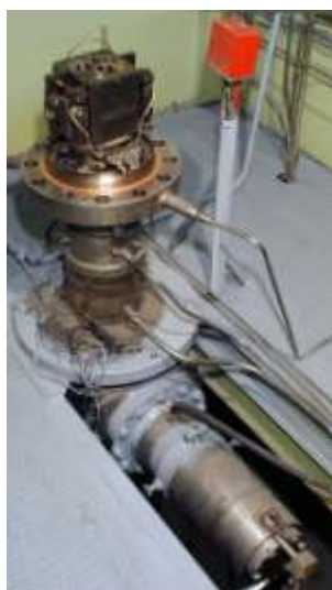
Рис. 4. Стенд для испытаний материалов пар трения в среде гелия
