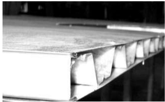
Рис. 6. Вид с торца подсобранной сэндвич-панели пола автобуса
