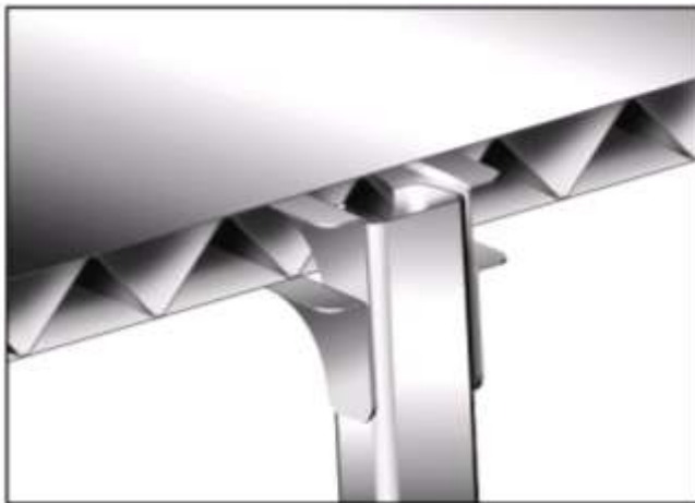
Рис. 1. Сэндвич-панель крыши автобуса
