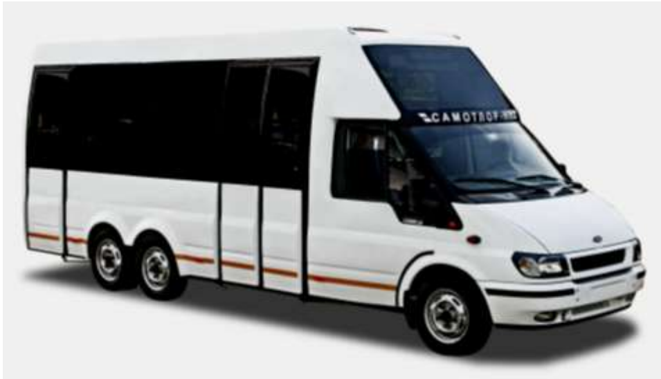
Рис. 4. Победитель номинации «Лучший микроавтобус» автосалона «КРОКУС ЭКСПО 2006» низкопольный переднеприводный городской автобус «Самотлор-3283»
