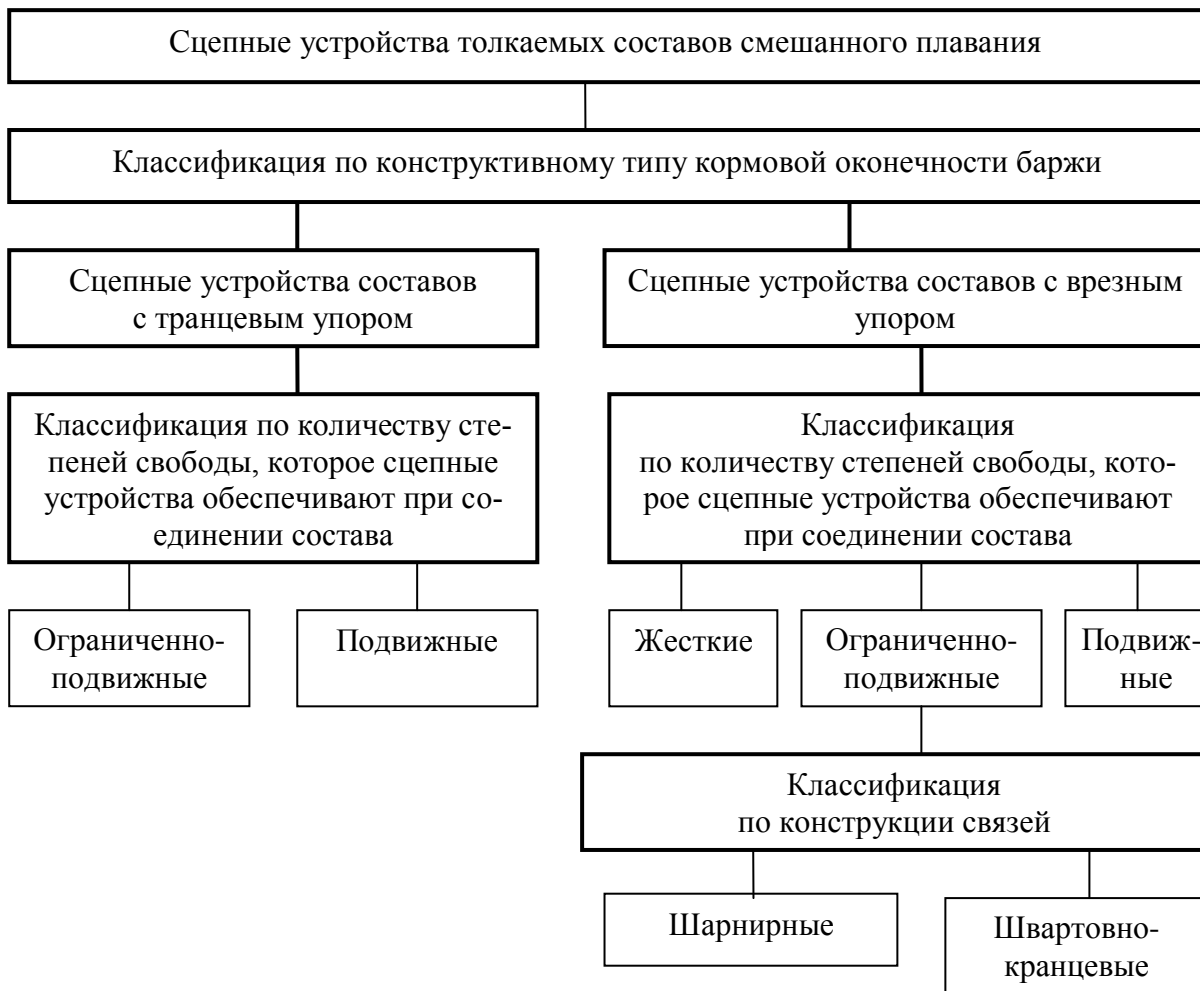
Рис. 3 Схема классификации сцепных устройств толкаемых составов
