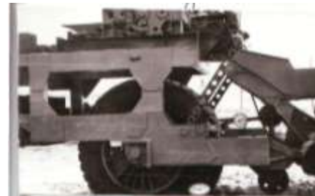
Рис. 6. Общий вид экспериментальной установки для исследования взаимодействия с грунтом крупногабаритного пневматического колеса при нагрузке 100-250 кН:
