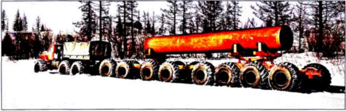
Буксировка прицепа на жестком дышле с использованием ВТС 6-6 УП-КМ1 "Полярник-Техник" (линейный тягач). Режим применяется при движении по автодорогам
