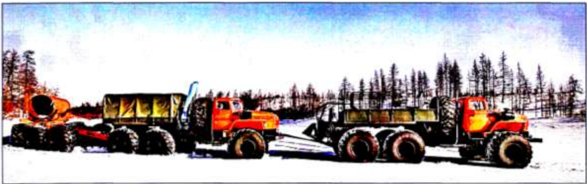
Совместная буксировка прицепа ВТС "Полярник-Буксировщик" и ВТС "Полярник-Техник" на жестком дышле. Режим применяется при на участках маршрута с повышенным сопротивлением движению (переметы, заносы, заболоченные участки)
