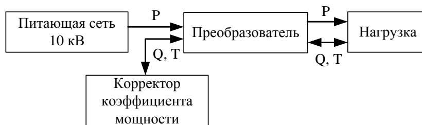
Рис. 2. Структурная схема потоков мощности при использовании ККМ
