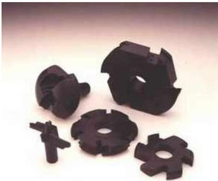
**Рис. 2. Внешний вид деталей, полученных методом холодного чернения**
