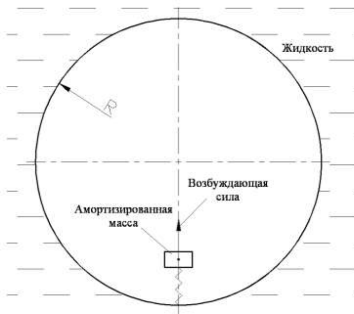
Рис. 5. Поперечное сечение оболочки с амортизированной точечной массой
