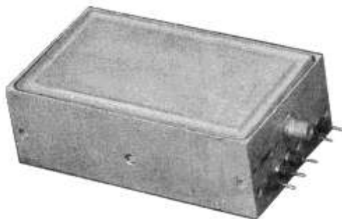
Рис. 9. Аттенюатор электрически управляемый с тремя секциями
