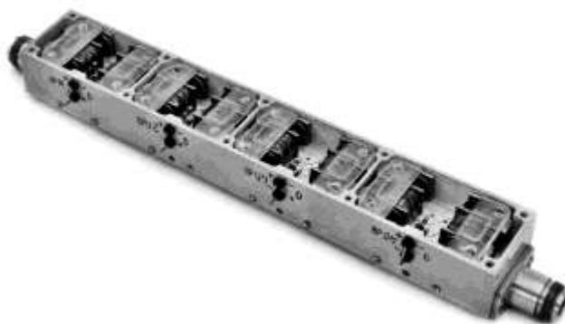
Рис. 6. Внешний вид аттенюатора со стороны системы электромагнитного переключения
