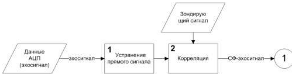
Рис. 1. Этапы предварительной обработки эхосигнала
