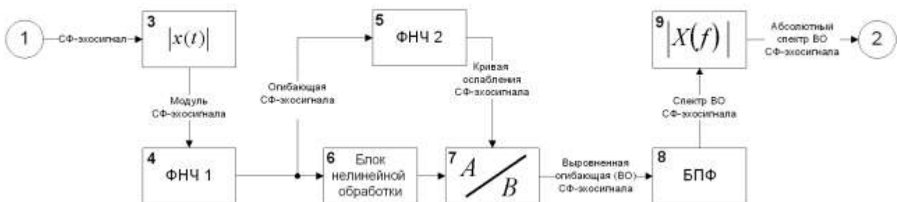
Рис. 2. Этапы дополнительной обработки СФ-эхосигнала
