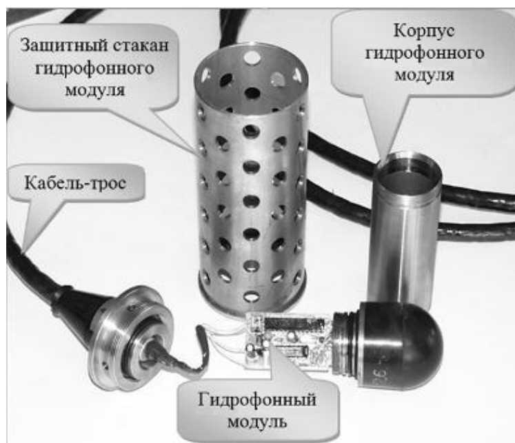
Рис. 3. Конструкция цифровой приёмной антенны
