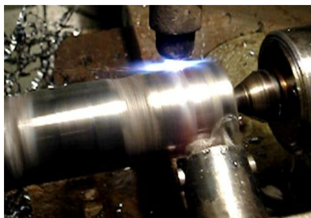
Рис. 3. Обработки нагретой поверхности детали охлаждаемым водой роликовым накатником с шириной кольца роликового подшипника 11 мм
