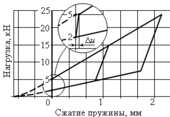
Рис. 3. Характеристика предварительно поджатой фрикционной кольцевой пружины
