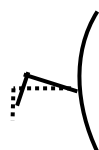
Рис. 1. Вариант деформации бортового перекрытия баржи-площадки пр.№Р-56 с холостыми балками сечением из неравнополочного уголка (а) и схема поперечного сечения деформированной холостой балки (б): (--- проектное положение сечения)
