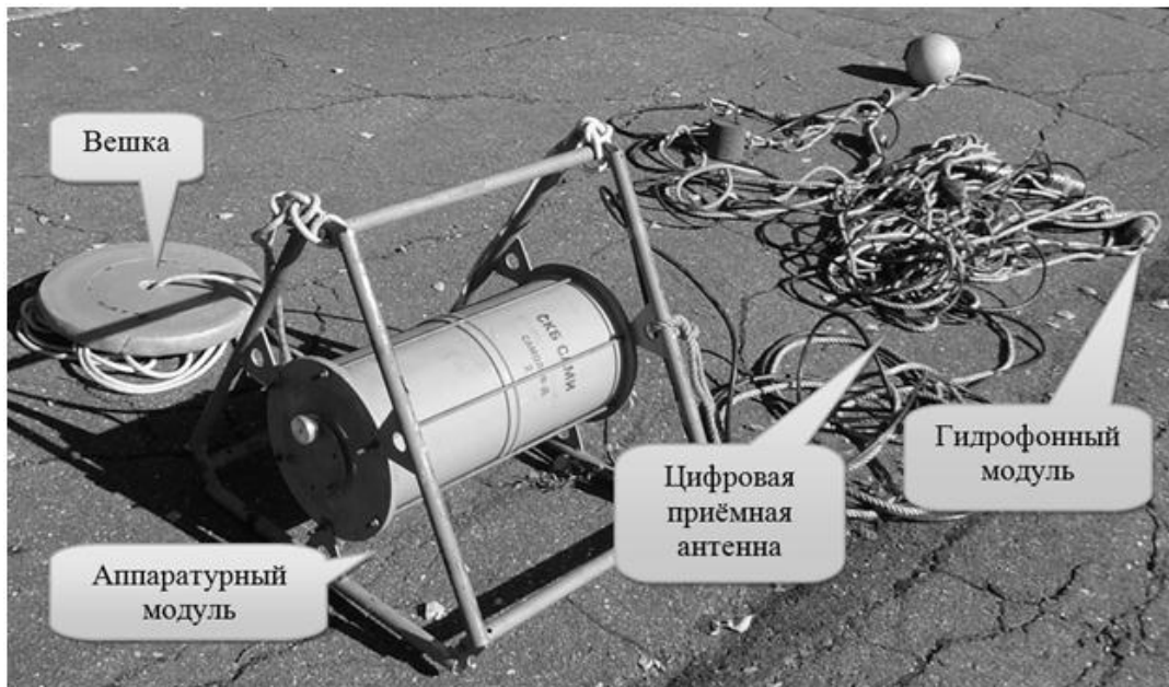
Рис. 1. Автономная морская сейсмоакустическая станция
