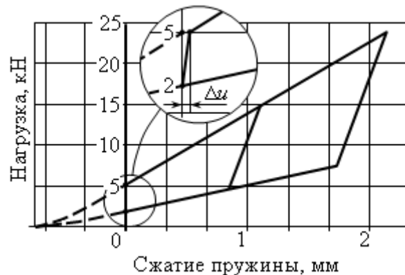
Рис. 3. Характеристика предварительно поджатой фрикционной кольцевой пружины
