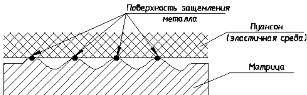
Рис. 2. Схема штамповки гофрированных панелей на жестком форм-блоке эластичной средой на гидравлическом прессе
