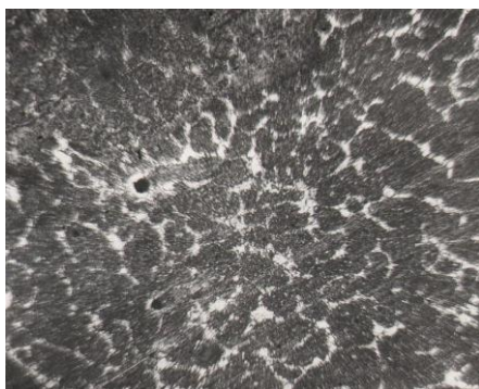
Рис. 3. Микрошлиф ( a , б , в ) поковки типа «Стержень», х100
