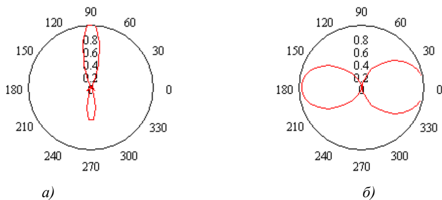
Рис. 7. Диаграмма направленности системы рамка – шар ( R=2.5\lambda , \epsilon = 5 ): a - в вертикальной плоскости; б - в горизонтальной плоскости)
