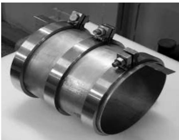
Рис. 2. Сборка и прихватка выводных пластин
