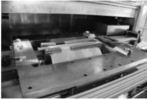
Рис. 3. Установка обечайки в приспособлении для сварки на рабочий стол УЛ-178М
