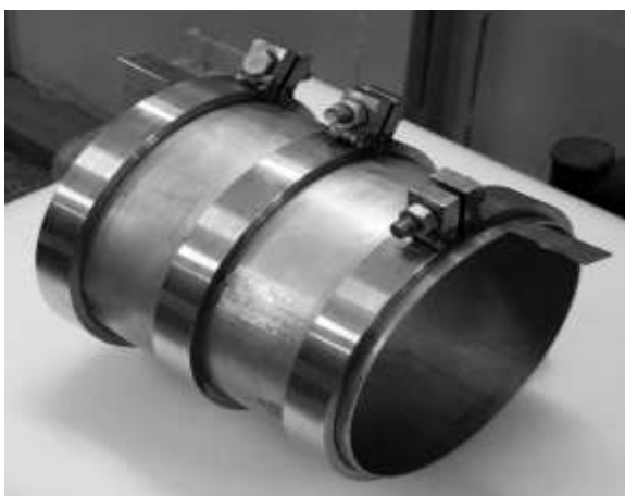
Рис. 2. Сборка и прихватка выводных пластин
