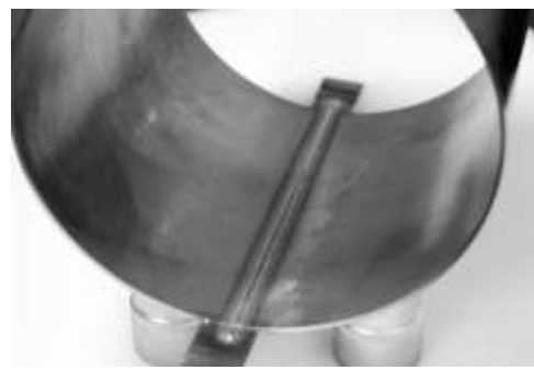
Рис. 5. Выполненный продольный сварной шов обечайки:
