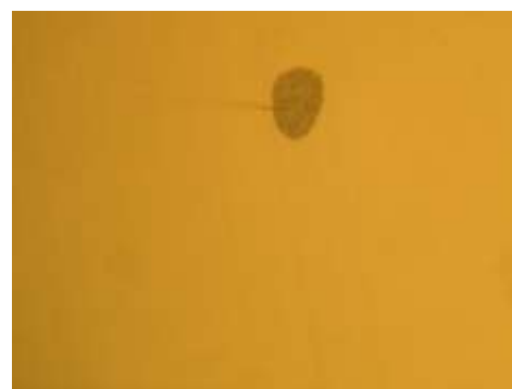
Рис. 2. Сульфидные включения в светлом поле зрения, \times 300
