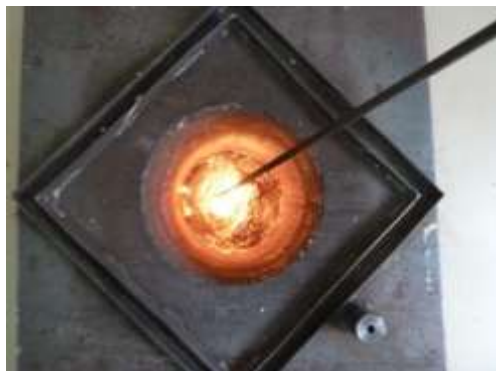
Рис. 1. Пиролиз частиц идет полностью, на поверхности расплава горит образующийся газ. (Система улавливания газа снята)
