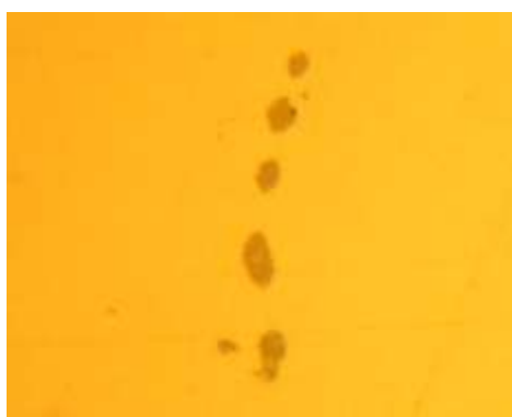
Рис. 1. Группа оксидных включений в светлом поле зрения, \times 300
