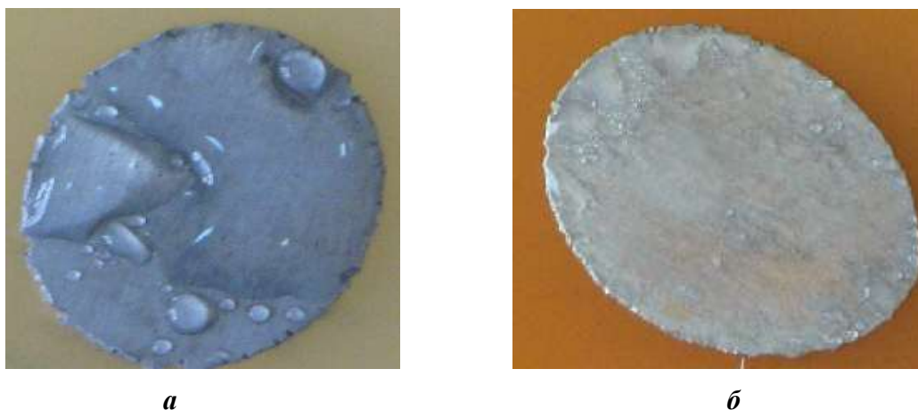
Рис. 1. Внешний вид образцов цинка через трое суток под воздействием бактерий: а - Echerichia coli 321-5; б - Pseudomonas aeruginosa 969 1
