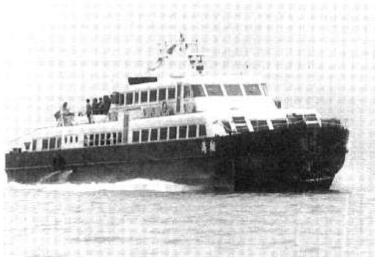
Рис. 5. Китайское судно с корпусом туннельного типа с жесткими боковыми скегами. Пассажирская модель 719-1
