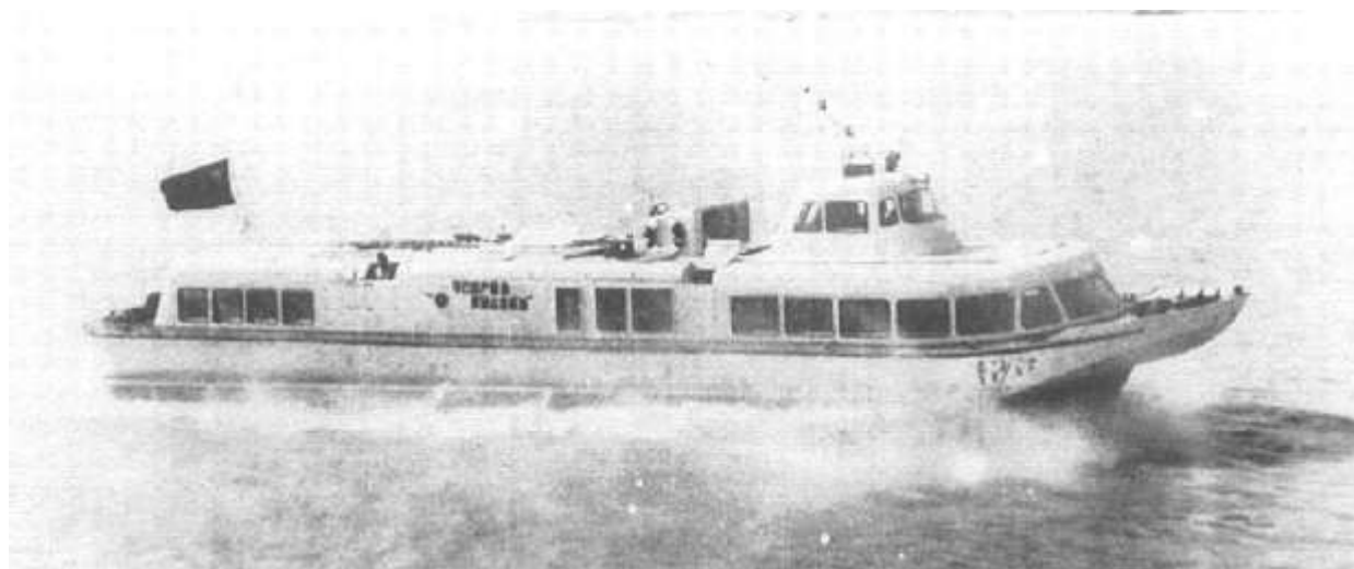
Рис. 6. Первое китайское пассажирское судно с корпусом туннельного типа с жесткими боковыми скегами (на реке Джин Сах)
