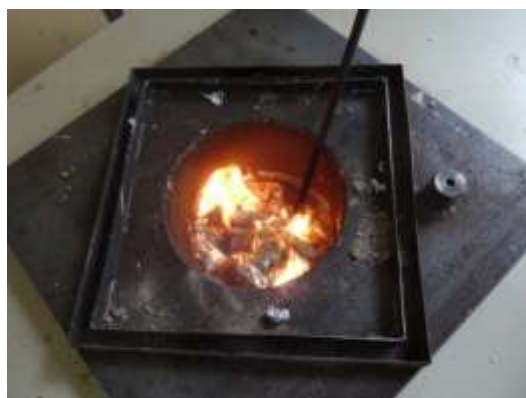
Рис. 2. Интенсивное газообразование «вспученная» поверхность теплоносителя. Пузырь достигает поверхности расплава, но газ еще скрыт слоем металла. (Система улавливания газа снята)
