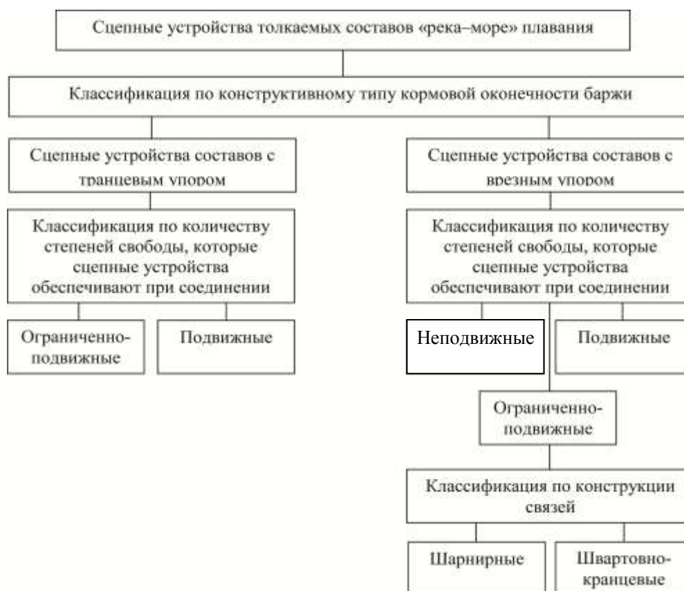
Рис. 4. Схема классификации сцепных устройств толкаемых судов
