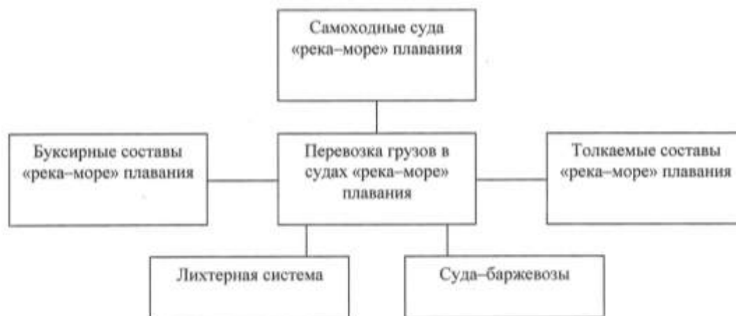
Рис. 1. Варианты транспортных систем для перевозки грузов в судах смешанного «река-море» плавания
