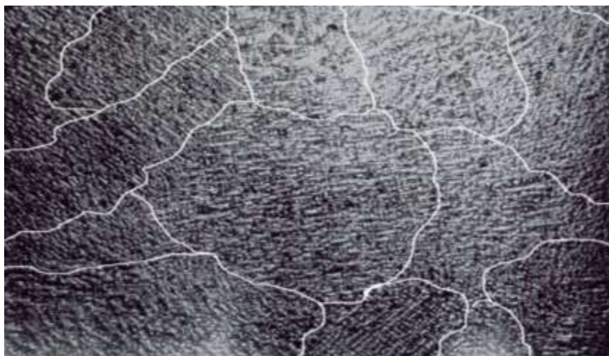
Рис. 4. Пакетное строение дендритных кристаллов в чугунах, \times 7
