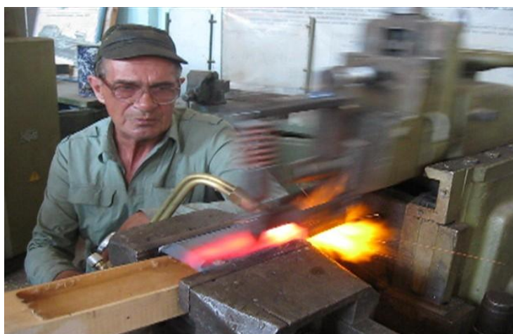
Рис. 3. Внешний вид строгания нагретой поверхности детали на строгальном станке
