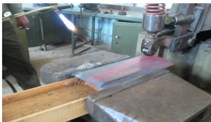
Рис. 4. Внешний вид накатывания нагретой поверхности детали роликовым накатником на строгальном станке
