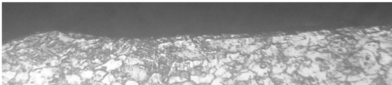
Рис. 6. Фотография поверхности среза детали после строгания с нагревом ( \times 200 )
