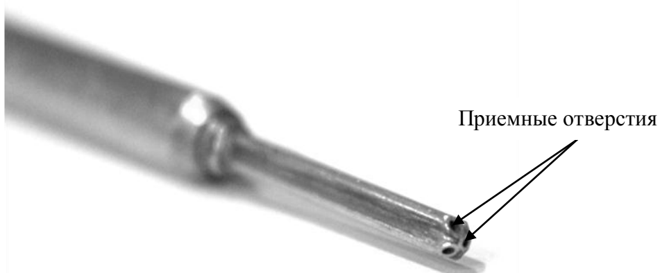
Рис. 2. Чувствительная часть пятиканального пневмометрического зонда
