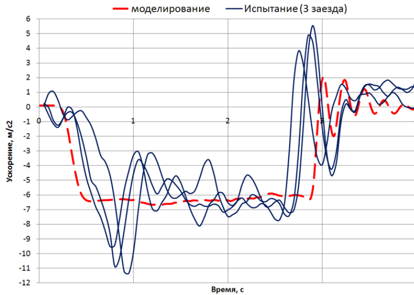
Рис. 6. Графики изменения замедления при торможении со скорости 50 км/ч
