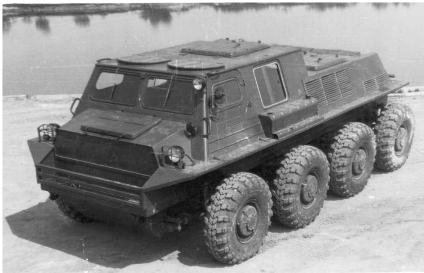
Рис. 2. Ходовой полноразмерных макет колесного шасси ГПИ-3901
