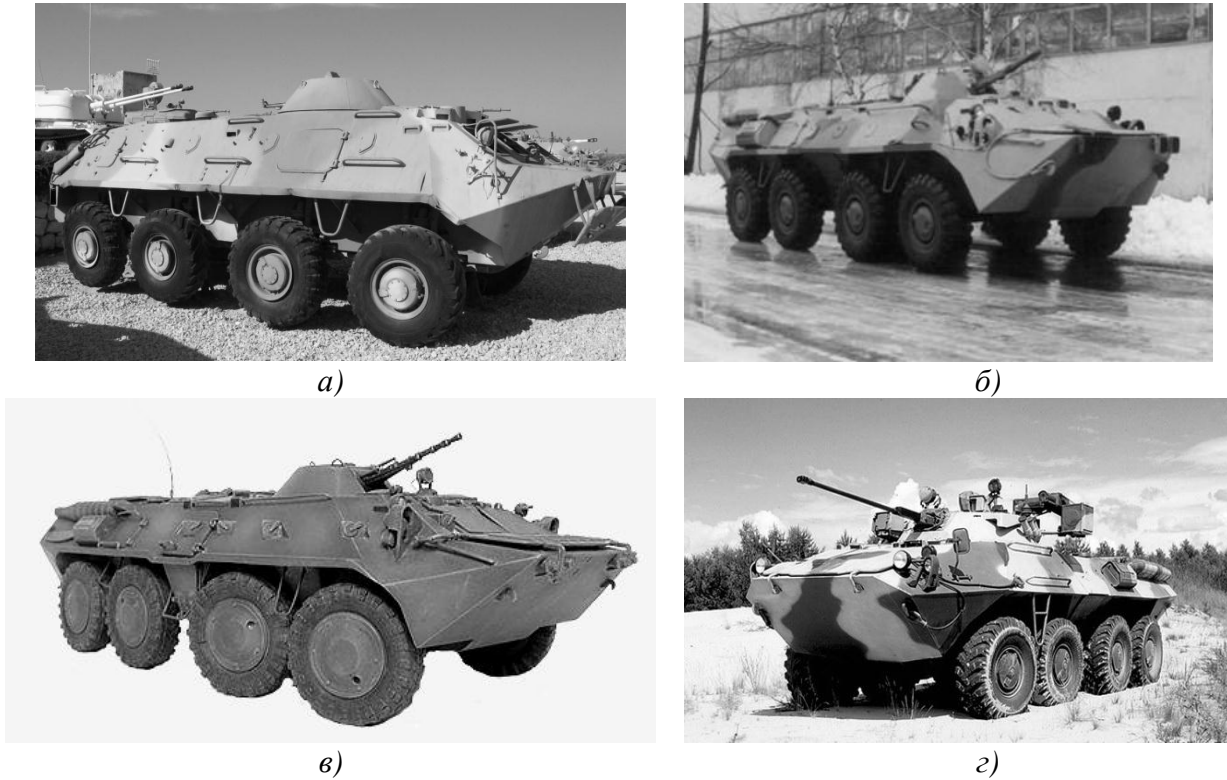
Рис. 1. Многоосные колесные машины: а – БТР-60; б – БТР-70; в – БТР-80; з – БТР-90
