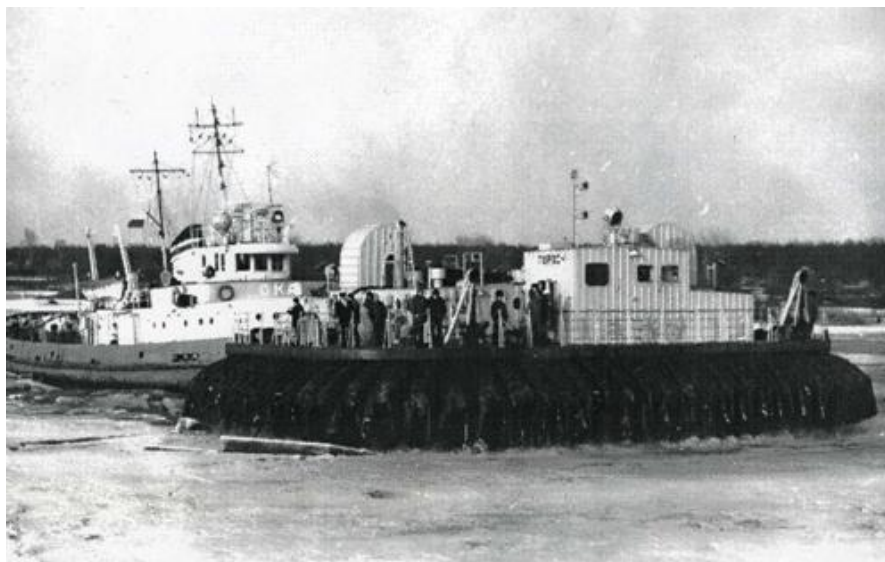
Рис. 1. Испытание состава: ледокол "Ока"+ЛПВП-107П на Волге
