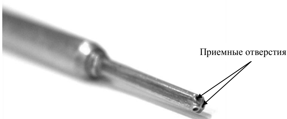
Рис. 2. Чувствительная часть пятиканального пневмометрического зонда
