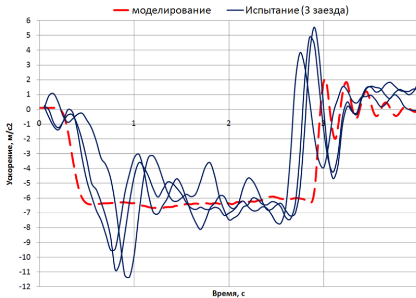
Рис. 5. Графики изменения замедления при торможении со скорости 40 км/ч
