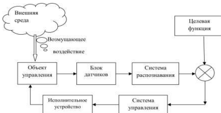
Рис. 1. Классическое представление системы «среда – объект – система управления»
