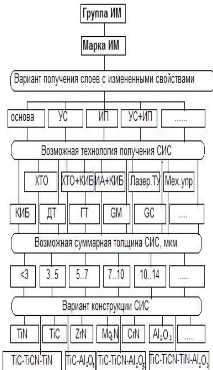
Рис. 1. Систематизация вариантов материала режущей части инструментов, имеющих слой с измененными свойствами (СИС) для их альтернативного выбора при проектировании процессов резания
