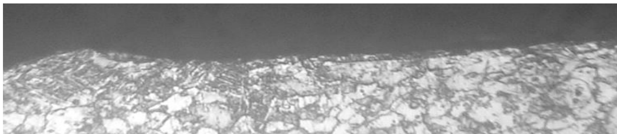
Рис. 6. Фотография поверхности среза детали после строгания с нагревом ( \times 200 )
