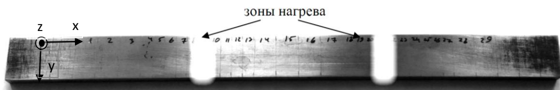
Рис. 1. Схема локального термического воздействия
