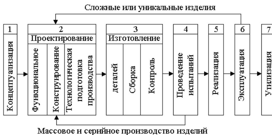
**Рис. 1.** Схема жизненного цикла оптико-механической системы прибора
