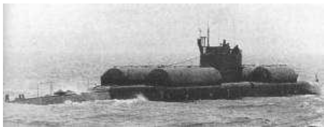
Рис. 5. Подводная лодка проекта 613Э с электрохимическими генераторами
