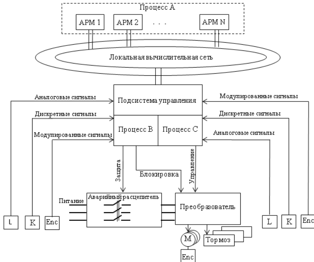
Рис. 4. Структурная схема системы управления (вариант 3): АРМ – автоматизированное рабочее место; K – дискретный датчик; L – аналоговый датчик; M – электродвигатель; Enc – датчик перемещения/поворота
