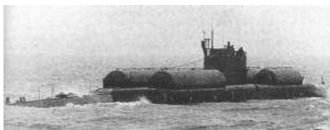
Рис. 5. Подводная лодка проекта 613Э с электрохимическими генераторами
