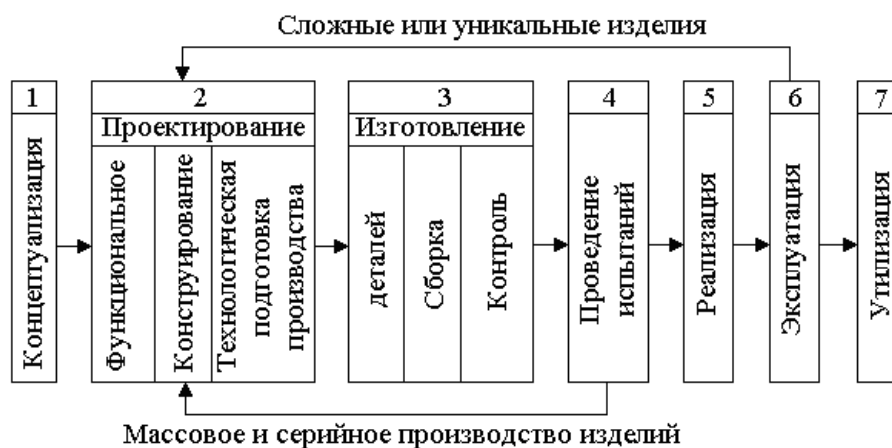
Рис. 1. Схема жизненного цикла оптико-механической системы прибора
