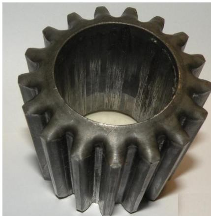
Рис. 6. Сателлит, изготовленный методом холодной объемной штамповки (сталь 20ХГНМТА)
