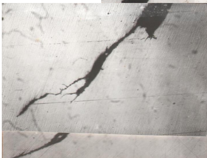
Рис. 6. Внешний вид дефекта на микрошлифе, x70
