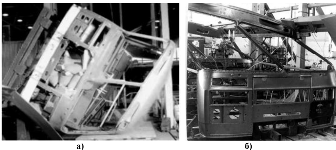
Рис. 1. Экспериментальные методы оценки пассивной безопасности автобусов: а – опрокидывание с уступа; б – квазистатическое нагружение
