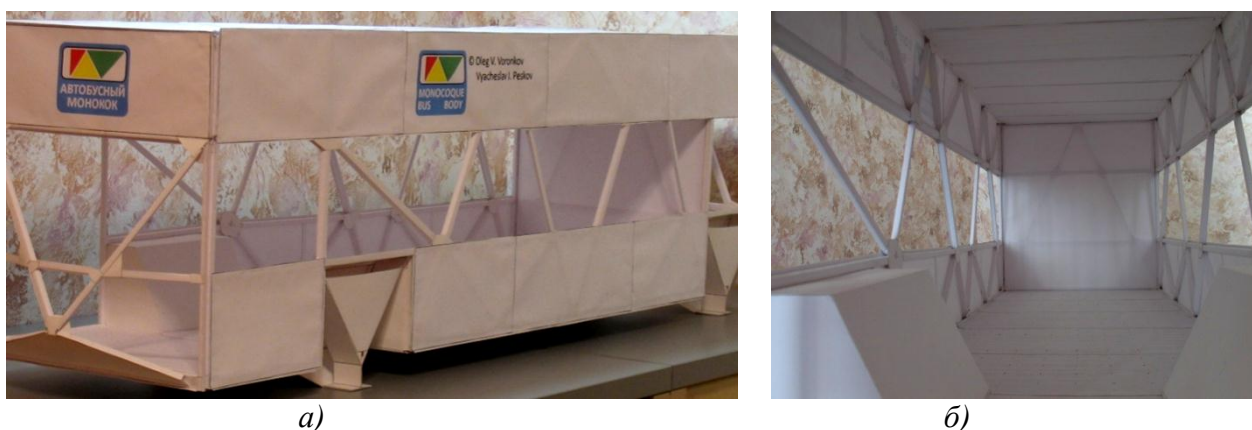
Рис. 2. Масштабный макет автобусного кузова типа «монокок»: а – вид снаружи; б – вид внутри
