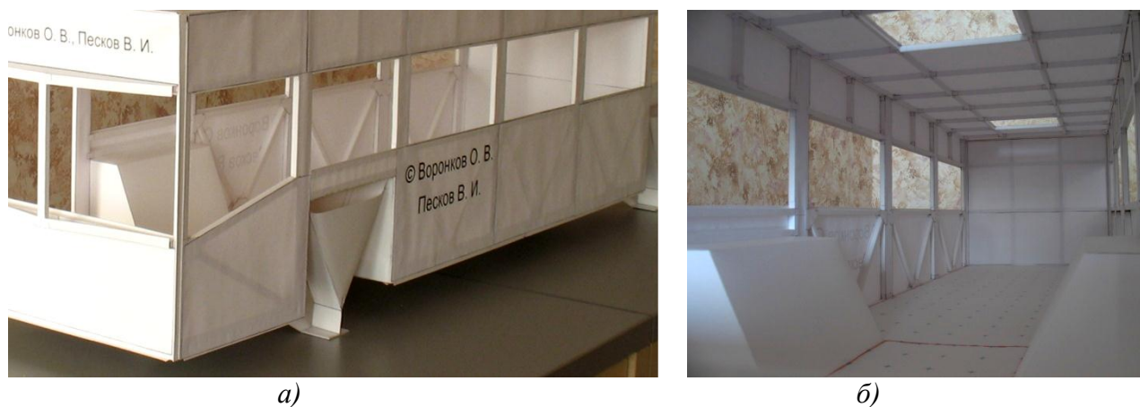
Рис. 3. Масштабный макет автобусного кузова каркасной конструкции: а – вид снаружи; б – вид внутри
