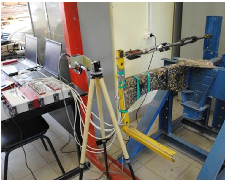
Рис. 1. Стенд для испытания локальных участков кузовных конструкций. Фрагмент нагружения силой F_1
