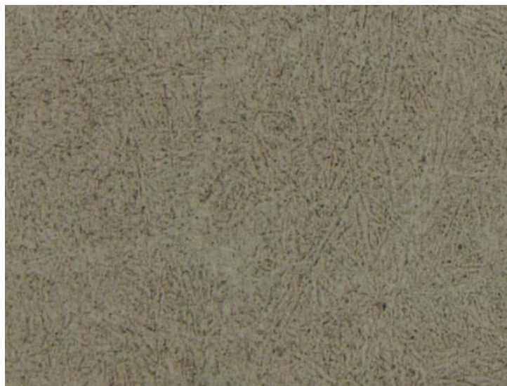
Рис. 1. Микроструктура образца из стали 20ХЗНЗМФБА после объемной термической обработки, x500
