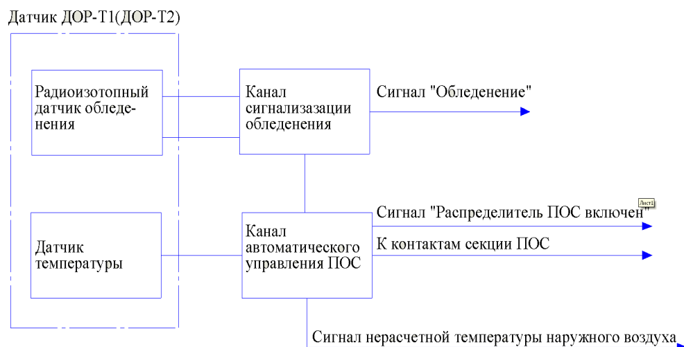
Рис. 11. Функциональная схема сигнализатора РАУС-1
