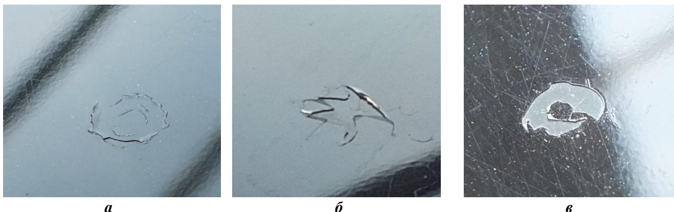
Рис. 3. Стадии дефекта в виде разрушения ЛКП при воздействии птичьего помета: а – сморщивание; б – растрескивание; в – отслоение
