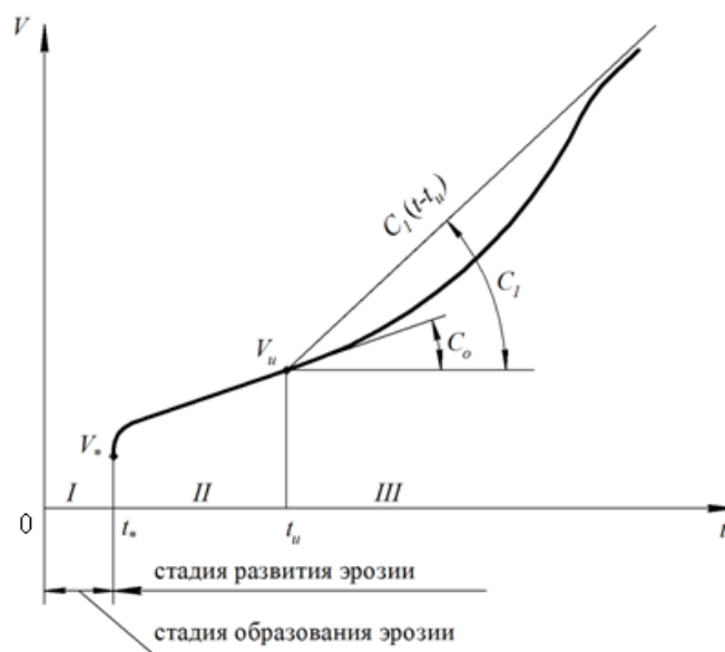
Рис. 1. Кривая кавитационной эрозии:
