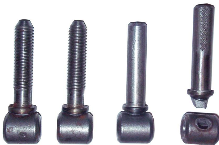
Рис. 6. Внешний вид сварных соединений и характер разрушения при испытаниях на отрыв
