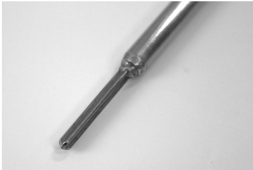
Рис. 3. Чувствительная часть пятиканального пневмометрического зонда
