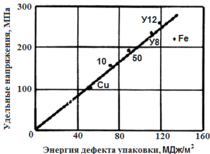
Рис. 5. Зависимость удельной силы трения от ЭДУ: режим резания: V=100 м/мин; S=0,157 мм/об.
