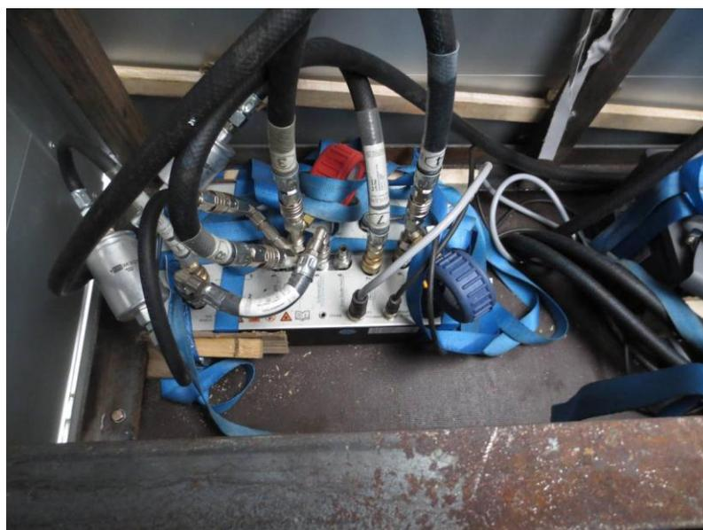
Рис. 7. Установка расходомера DFL3x в кузове автомобиля
