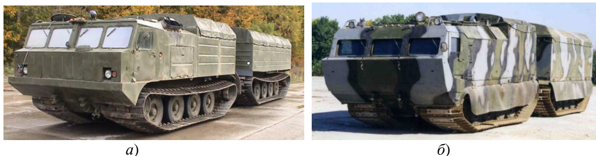
Рис. 3. Двухзвенные гусеничные транспортеры: а - ДТ-10П семейства «Витязь»; б - ДТ-10ПМ семейства «Вездесущий»
