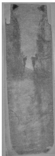
Рис. 4. Серный отпечаток с осевого темплетта остова слитка массой 7 т рельсовой стали, полученного методом выливания жидкой серцевины через 90 мин после заливки
