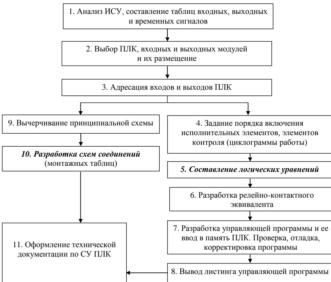
Рис. 1. Блок-схема алгоритма проектирования системы управления с применением ПЛК
