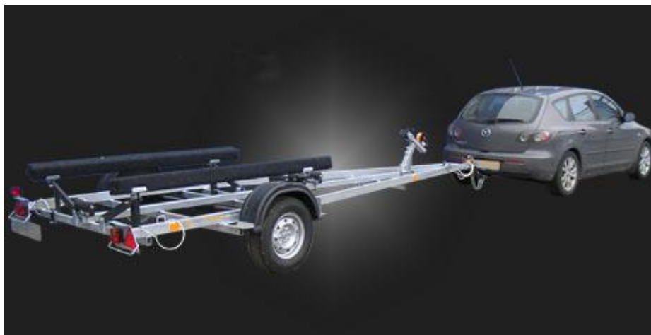
Рис. 1. Легковой автопоезд с прицепом, оборудованным инерционной тормозной системой
