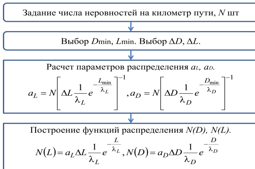
Рис. 4. Блок-схема методики моделирования дискретных неровностей (упавшие деревья, ветки и корневища) лесных дорог
