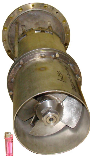
Рис. 2 Фото экспериментального участка (выемной части) стенда ФТ-4А
