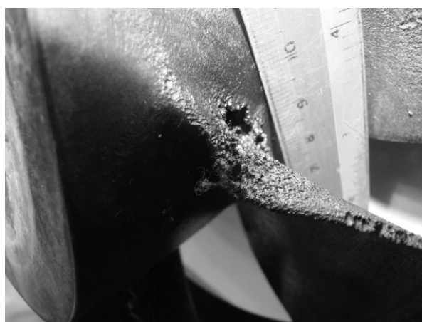
Рис. 7. Эрозионный износ выходных кромок лопаток после ресурсных испытаний
