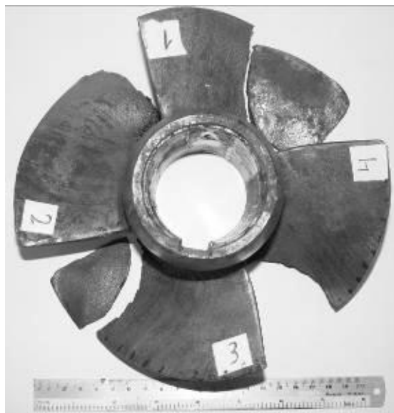
Рис. 8. Разрушение лопаток колеса
