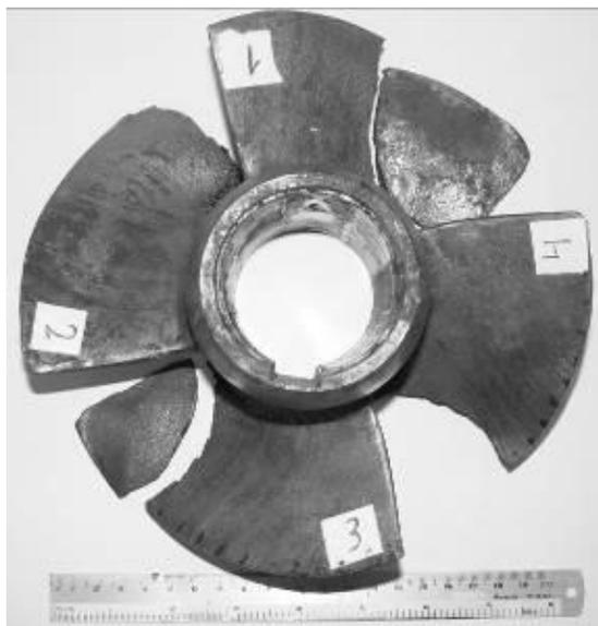
Рис. 8. Разрушение лопаток колеса
