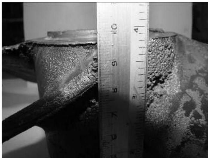
Рис. 9. Разрушение ступицы колеса
