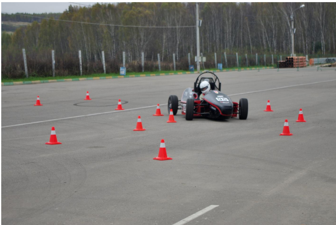
Рис. 5. Натурное испытание «движение по траектории постоянной кривизны»
