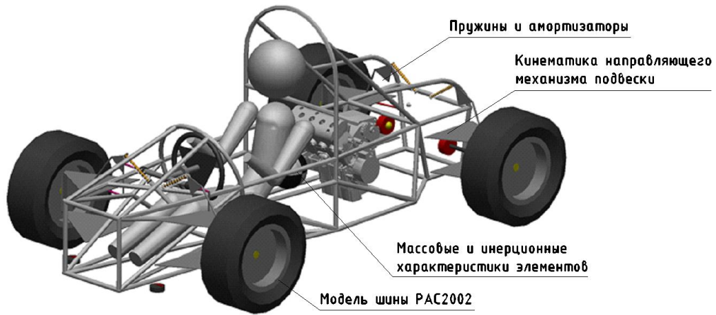
Рис. 3. Схема модели спортивного автомобиля класса «Formula Student»
