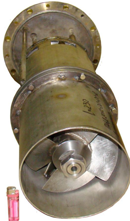
Рис. 2. Фото экспериментального участка (выемной части) стенда ФТ-4А
