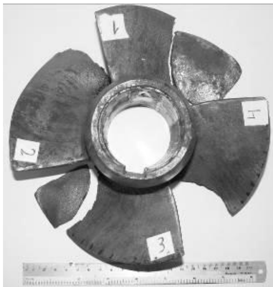
Рис. 8. Разрушение лопаток колеса
