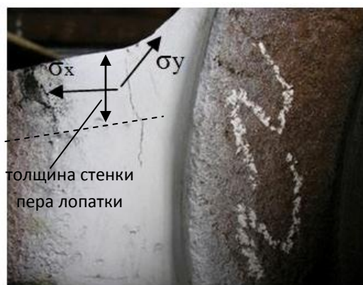
Рис. 3. Трещины в районе сварного соединения пера лопатки с цапфой
