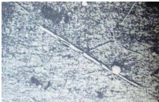
Рис. 1. Микроструктура сплава АК12 ( \times 100 ). Травление 10% H_3PO_4
